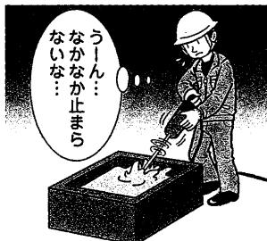
それは、回転軸を握つて止めようとする危険行為自体が、軍手着用であれ素手であれ同質といえるからである。また、回転羽根軸と駆動モーターの連結部分・継手部分にボルト等の凸部分があれば、これによる巻き込みの危険があるので埋頭型等に改善措置しておく必要がある。
